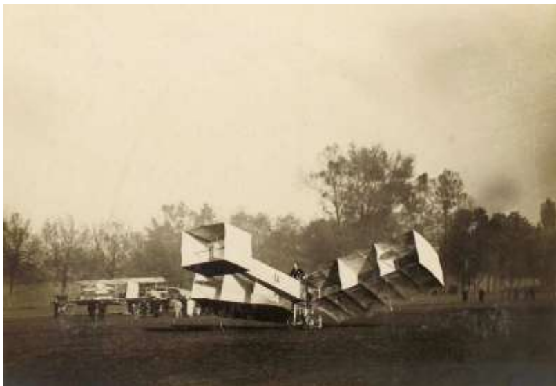
Figura 5 - O 14-bis em 12 de novembro de 1906, já com os ailerões instalados; ao fundo, o Blériot IV , projetado por Henri Blériot, com sua distinta cauda elipsoidal, o qual nunca voou.
